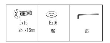
Bitte ziehen Sie die Schrauben während der Montage noch nicht fest. Die Schrauben erst in ihrer Position fixieren und am Ende der Montage alle Schrauben festziehen.
