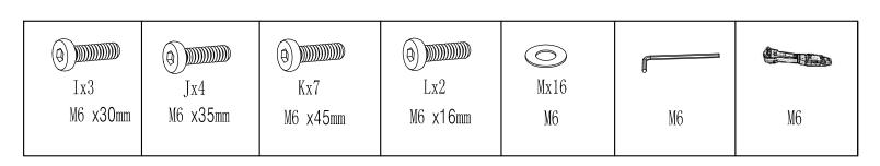
Bitte ziehen Sie die Schrauben während der Montage noch nicht fest. Die Schrauben erst in ihrer Position fixieren und am Ende der Montage alle Schrauben festziehen.
